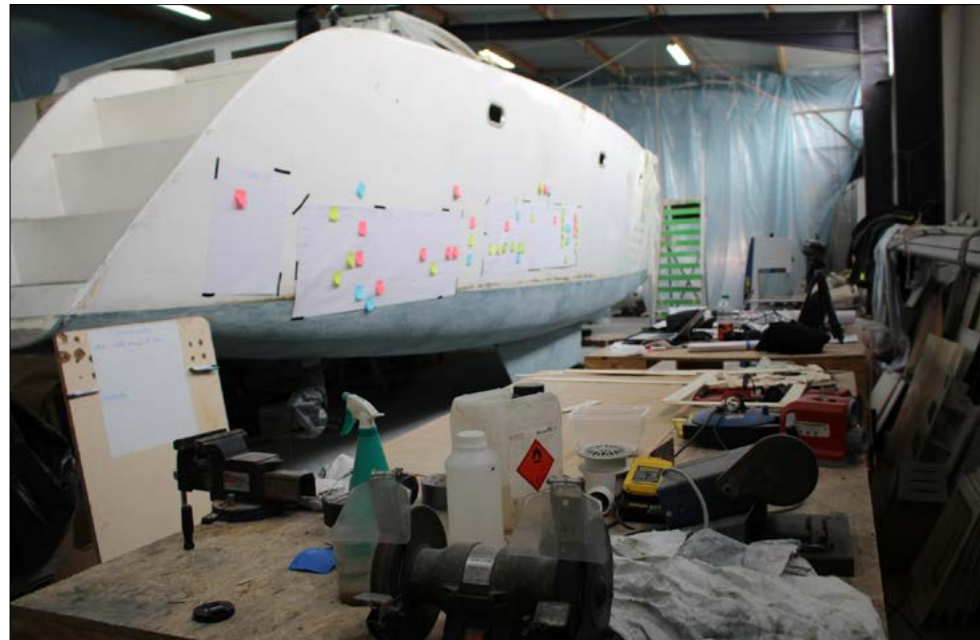
Zai Zai entièrement désossé pour repartir sur des bases saines avec sur son bordé des post-it de toutes les couleurs : en rouge ce qui concerne les systèmes, en vert la menuiserie et en bleu la stratification.
